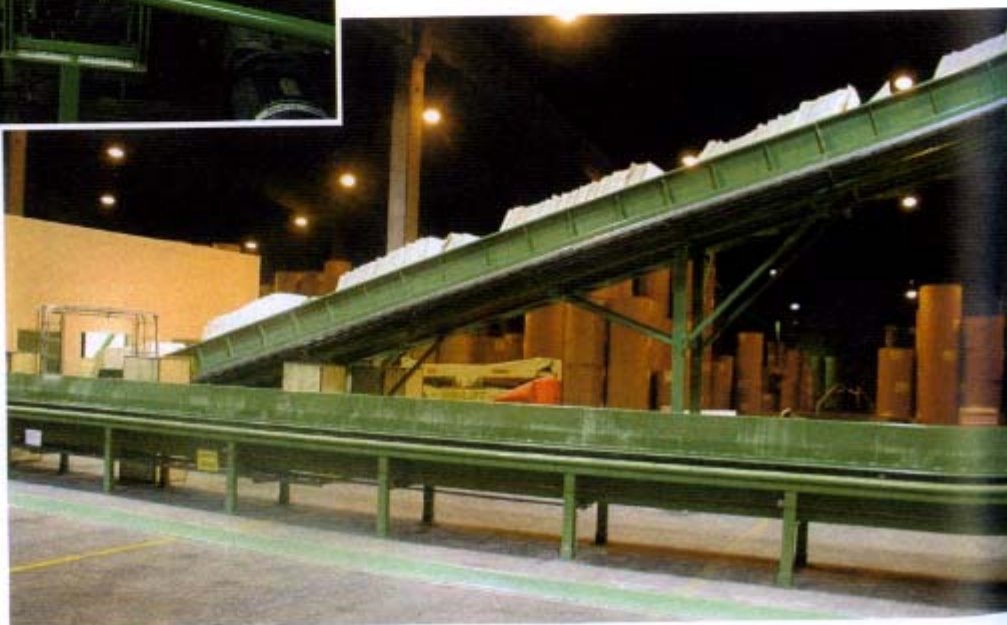
Cette installation est commandée par un seul opérateur, qui assure le chargement des balles et le déchargement des camions.
